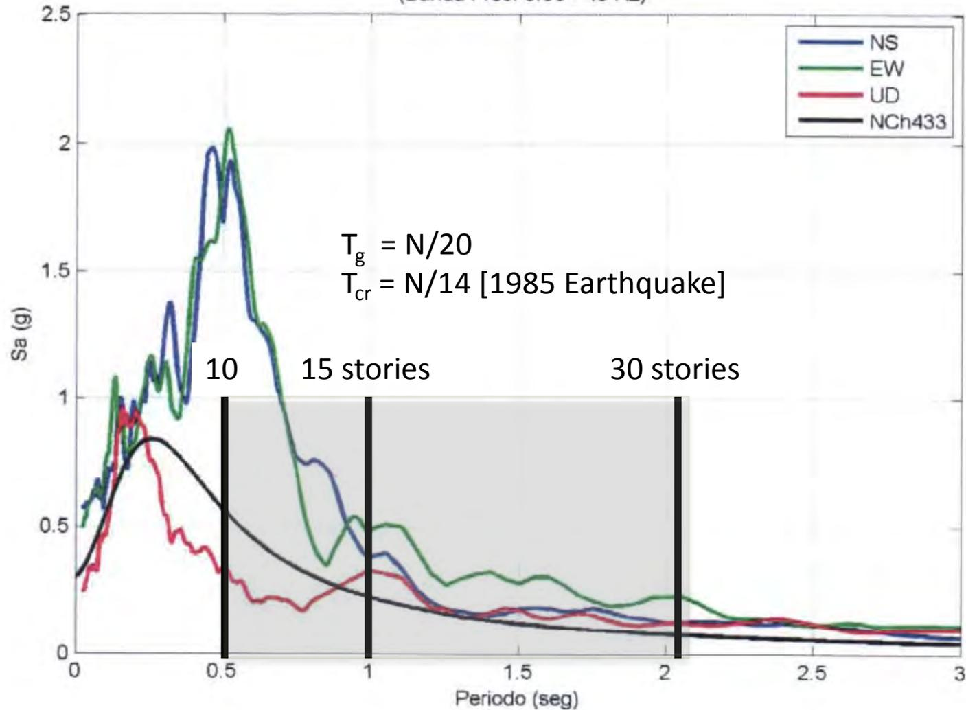
Figura 9 Comparación Espectro de Diseño Norma Chilena NCh433 – Estación CRS MAIPU RM. (Ver Nota General)
