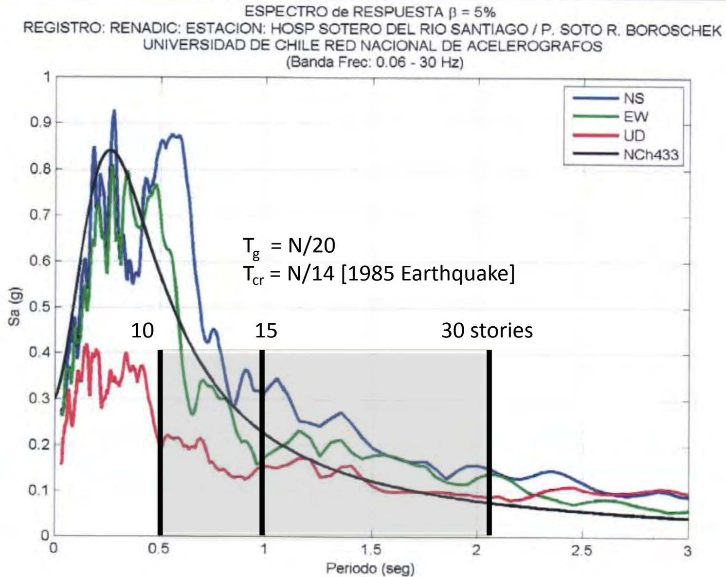
**Figura 15 Comparación Espectro de Diseño Norma Chilena NCh433 – Estación Hospital Sotero del Río RM.**
