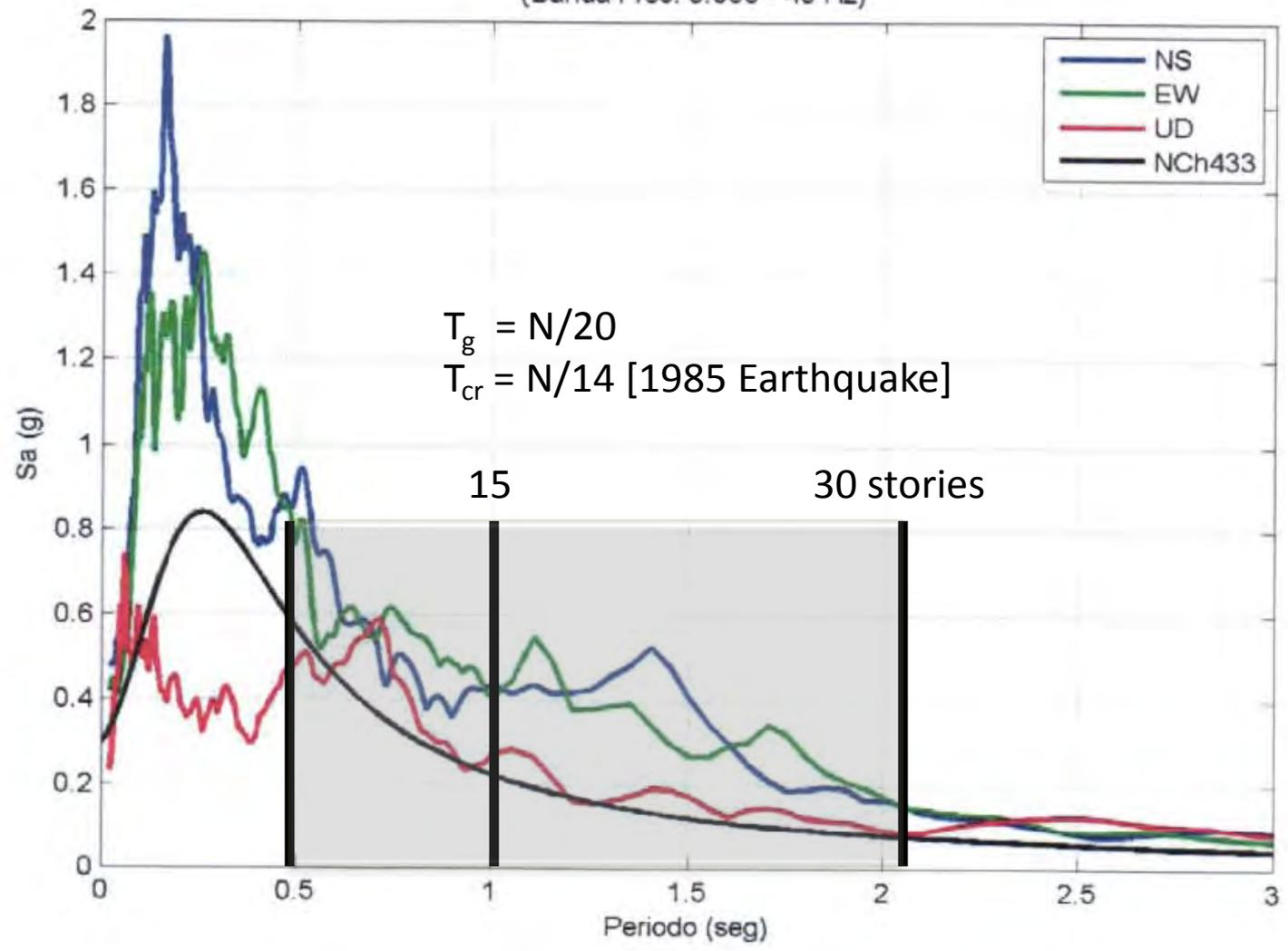
Figura 18 Comparación Espectro de Diseño Norma Chilena NCh433 – Estación Hospital Curico.
